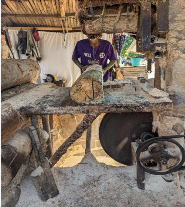
(腹押しノコでせつせとファルカタ原木を製材するフィリピンの製材工場。かなり原始的だ)
